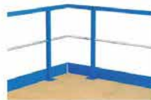
2 Garde corps : Potelet tube 45 x 45 H 1100 Main courante en C de 51 Lisse intermédiaire en tube Ø22 Plinthe H 150 mm
