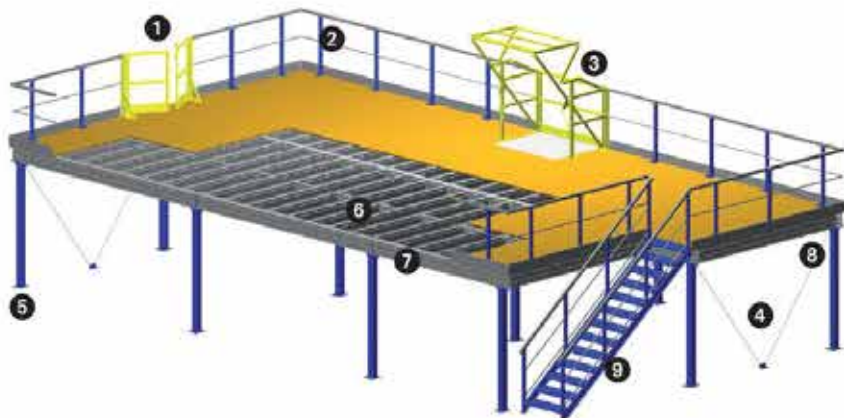
2 Garde corps : Potelet tube 45 x 45 H 1100 Main courante en C de 51 Lisse intermédiaire en tube Ø22 Plinthe H 150 mm
