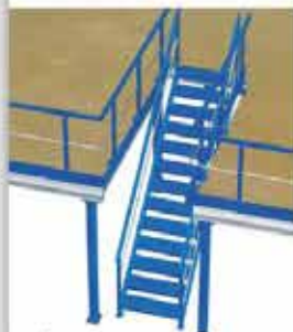
9 Escaliers : - Intégrés ou extérieurs - 2 largeurs : 900 et 1100 hors tout - Pente 38 à 45°
