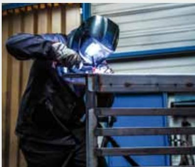
Assemblage d'un châssis par procédé de mécano-soudure
